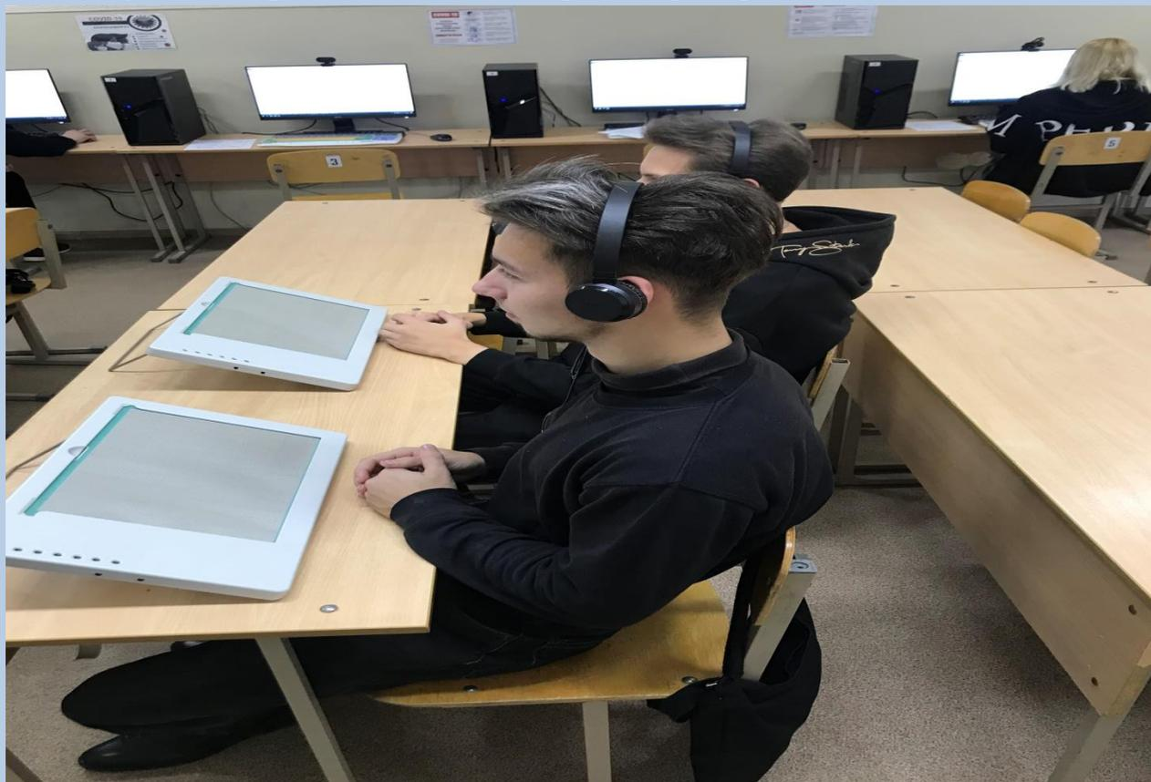
Дисплей с использованием системы Брайля (рельефно-точечный шрифт) с установкой для обеспечения инклюзивного образования
